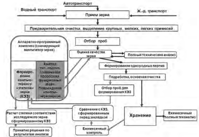
Рис. 2. Схема контроля качества и состояния зерна при формировании и хранении партий с применением сканирующего анализатора зерна (автор разработки к.т.н. Т. С. Штейнберг).
