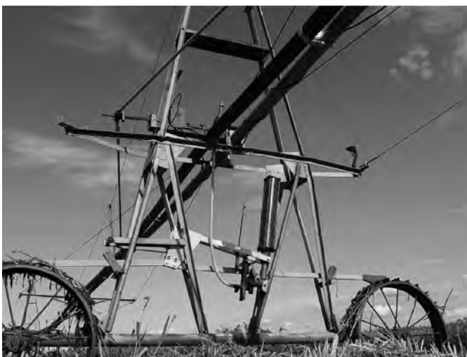
Рис. 5. Новая многофункциональная дождевальная машина с полиэтиленовым трубопроводом «Волга-СМ».
