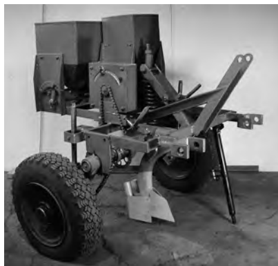
Рис. 3. Модульная установка с оборудованием для посева зерновых культур и внесения минеральных удобрений.
