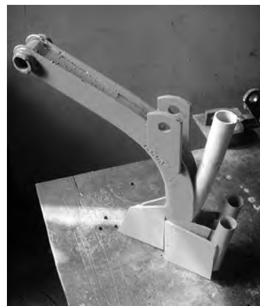
Рис. 1. Сошник для посева зерновых культур и внесения минеральных удобрений.
