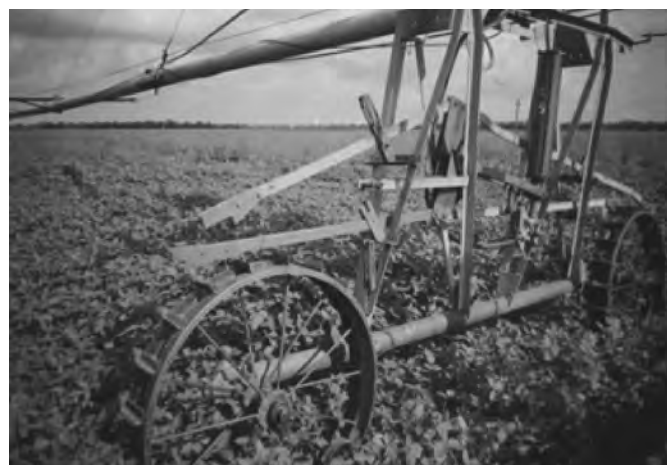
Рис. 2. Дождевальная машина «Фрегат» реверсивного передвижения.
