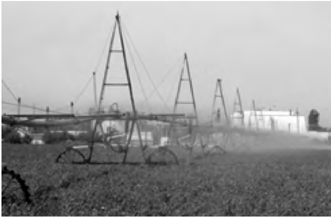
Рис. 4. Низконапорная дождевальная машина «Фрегат».
