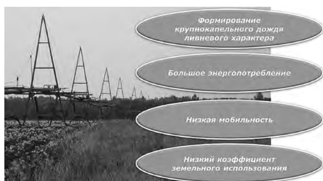
Рис. 1. Основные недостатки серийных дождевальных машин.
