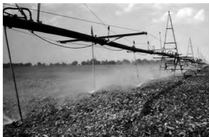
Рис. 3. Дождевальная машина «Фрегат» с устройствами приповерхностного дождевания
