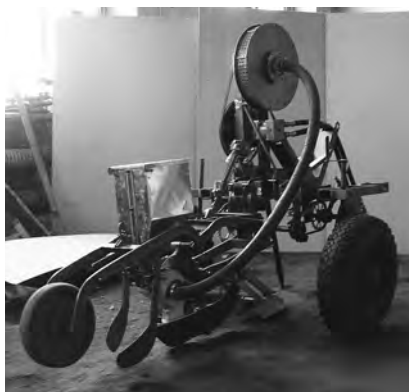
Рис. 4. Модульная установка с оборудованием для посева мелкосеменных культур.
